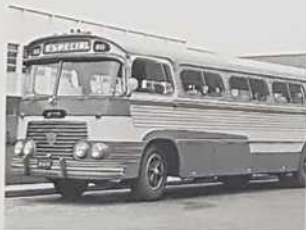
B 76 motor de 195 hp e direção hidráulica.
