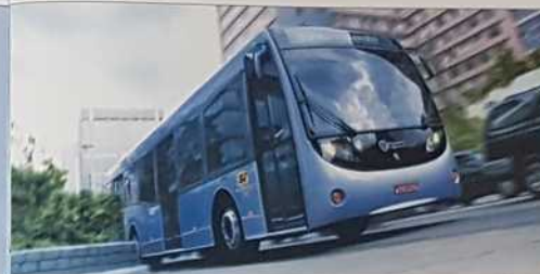
L 94: ônibus urbano de motor traseiro e piso baixo
