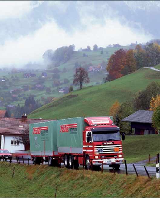
O modelo carro-chefe da nova série 3, o R143, foi adaptado com um motor turbo V8 de 470 hp.
