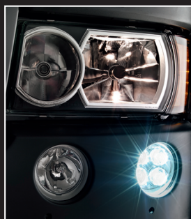
Farol de xênon com máscara negra e luz diurna no para-choque com tecnologia LED.
