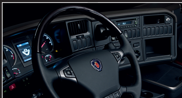
Exclusivo volante em couro com todos os controles à mão. Base em madeira e controle de rádio incorporado.
