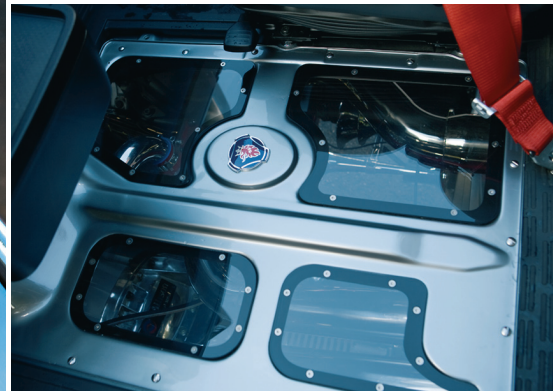
Esquerda: Nenhum detalhe foi esquecido. Acima: Parece familiar? O projetista de Bergendahl, Jan Richter, criou sua própria variante do grifo da Scania. Embaixo: o assoalho da cabine é feito de vidro, o que permite ver a caixa de câmbio.
