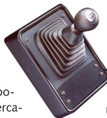
7 marchas, modelo GR 801, com Comfort Shift – CS, sistema eletropneumático que reduz o esforço do motorista para as trocas de marcha.
