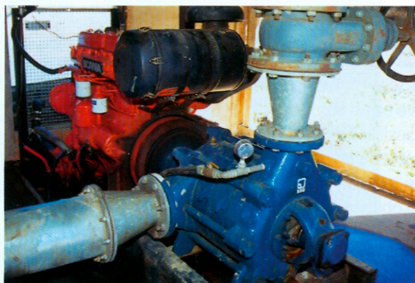
Motores Scania: Potências variam de 150 a 300 CV.
