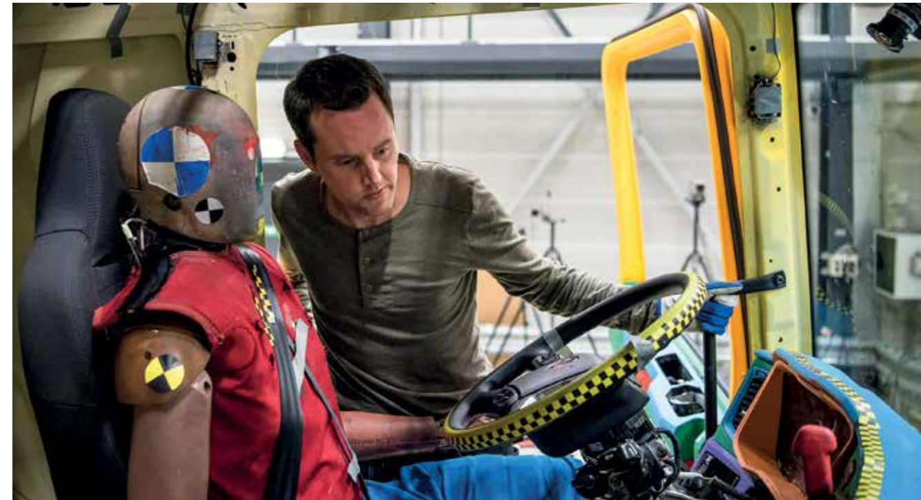
▲ Dan Loftén, responsável por todos os testes de colisão na nova geração de caminhões, inspeciona Thor antes de um dos testes.
